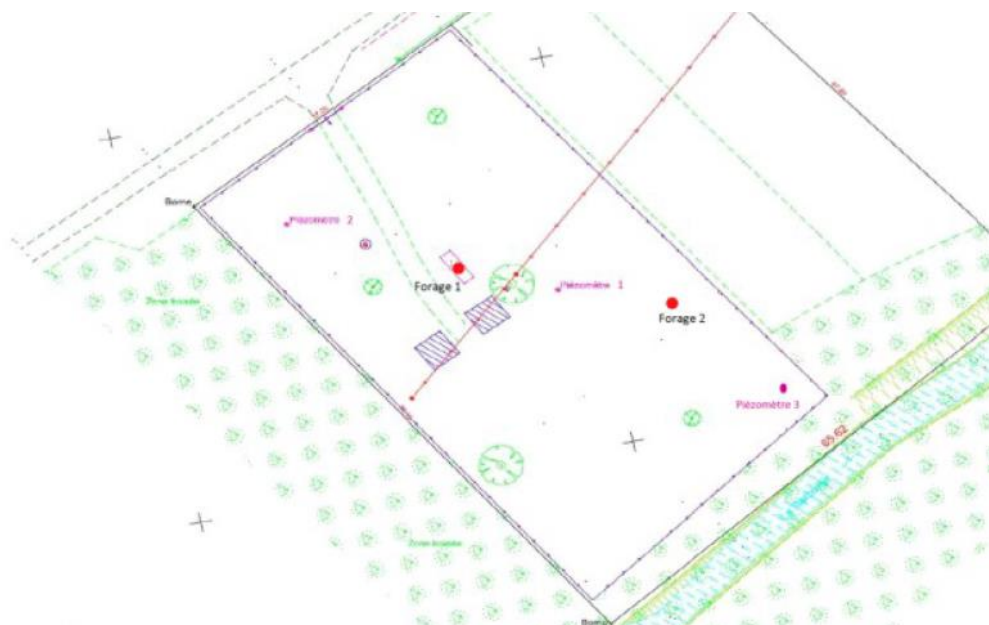
Figure 4 : Présence d'autres ouvrages dans le périmètre de protection immédiate du captage de Montsuzain. (R.Lemoine, Octobre 2018)
